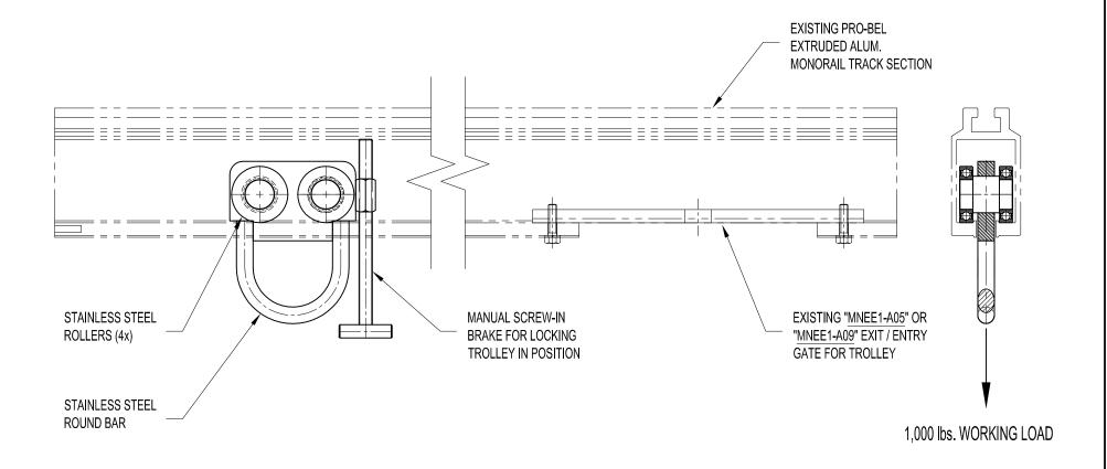
TR9-001SB: PRO-BEL STANDARD MONORAIL TROLLEY WITH BRAKE FOR GENERAL APPLICATION
